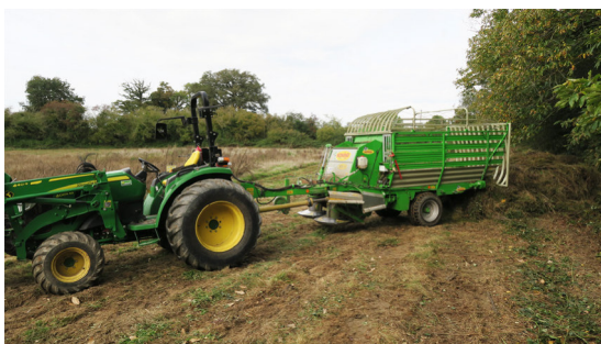
Fauchage en milieu humide - tracteur avec remorque autochargeuse pour export de la matière en vrac
