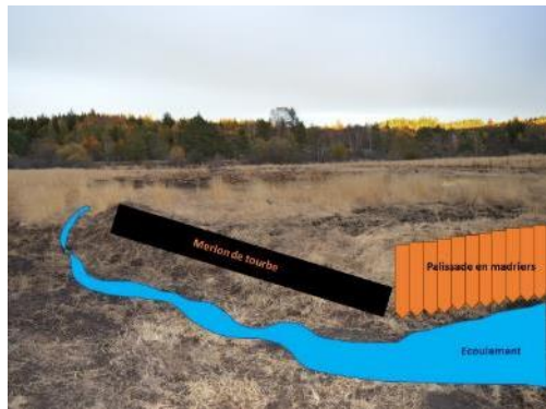
6 - Prolongement des palissades par un merlon pour orienter les écoulements
