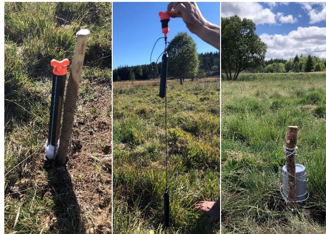
Piézomètre avec sonde automatique
