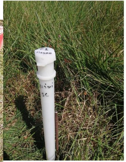
À la pose de chaque tube, un relevé pédologique a été effectué suivi d'une prise manuelle : hauteur totale du tube après coupe, hauteur à la surface du sol après pose, Hauteur sous terre :
