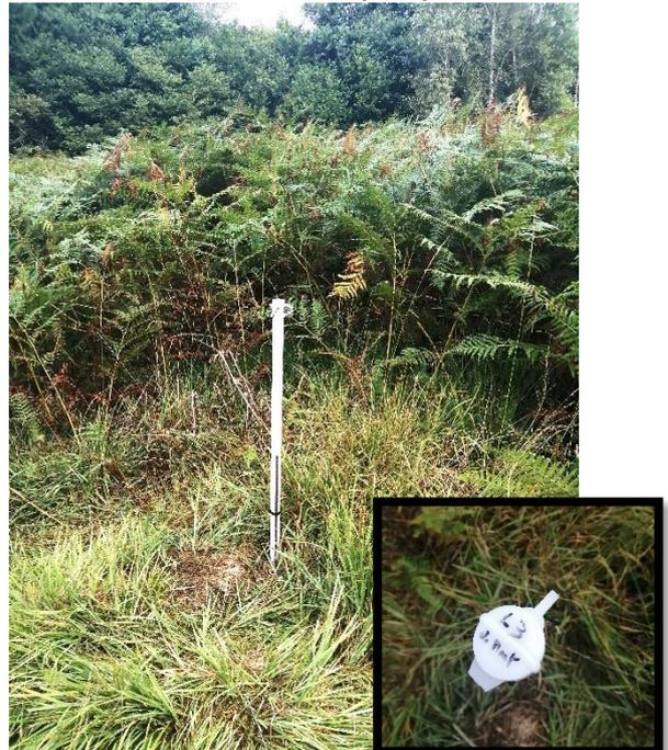
À la pose de chaque tube est effectué une prise manuelle avec relevé pédologique, hauteur totale du tube après coupe, hauteur à la surface du sol après pose, Hauteur sous terre :
