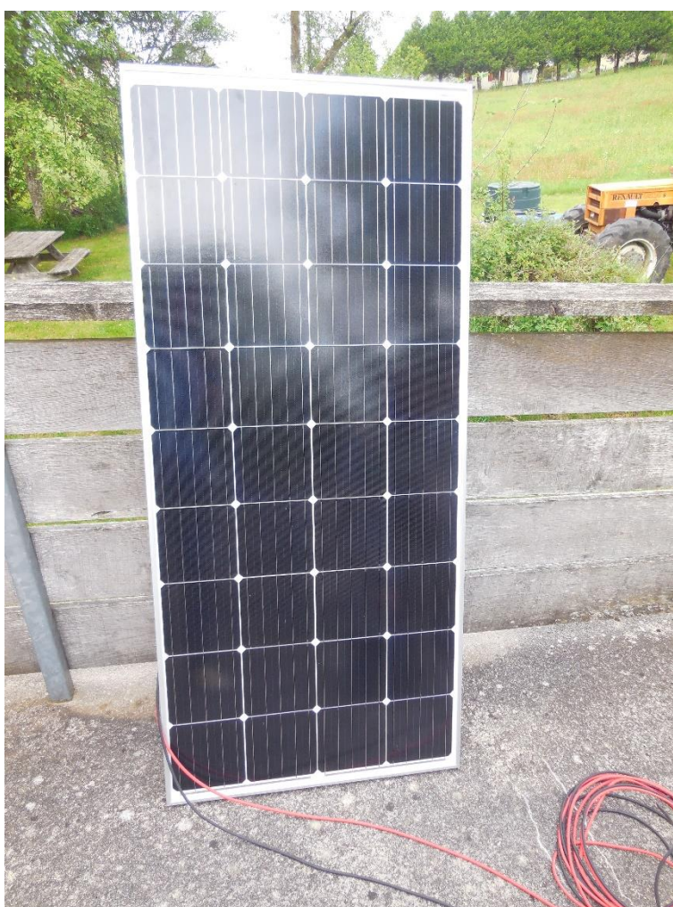
Photographie 6: Panneau solaire monocristallin 175 W utilisé
